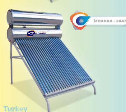
Tüp adeti : 24 Tüp boyutları 47x1800 160 L Sıcak su kapasitesi Soğuk su kapasitesi 160 L Soğuk su girişi 1/2" 3/4 Sıcak su girişi 304 krom / nikel İc depo malz. Dış yüzey malz. 430 krom / nikel Poliüretan İzolasyon malz. 45'lik statik boyalı boru profil Konstrüksiyon yapısı
