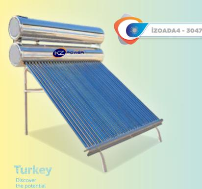
Tüp adeti : 30 Tüp boyutları 47x1800 Sıcak su kapasitesi 190 L Soğuk su kapasitesi 1901 Soăuk su airisi 1/2" 3/4" Sıcak su girisi İç depo malz. 304 krom / nikel Dış yüzey malz. 430 krom / nikel İzolasyon malz. Poliüretan Konstrüksiyon yapısı 45'lik statik boyalı boru profil
