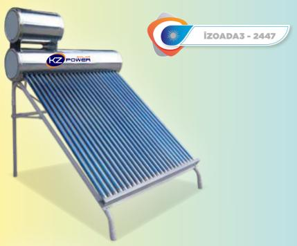
Tüp adeti : 24 47x1800 Tüp boyutları Sıcak su kapasitesi 160 L Soğuk su kapasitesi 40 L Soğuk su girişi 1/2" Sıcak su girişi 3/4" İc deno malz. 304 krom / nikel Dıs vüzev malz. 430 krom / nikel İzolasvon malz. Poliüretan Konstrüksiyon yapısı 45'lik statik boyalı boru profil
